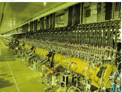
⑥J-PARC直線型加速器ドリフトチューブリニアック 写真提供: J-PARCセンター
