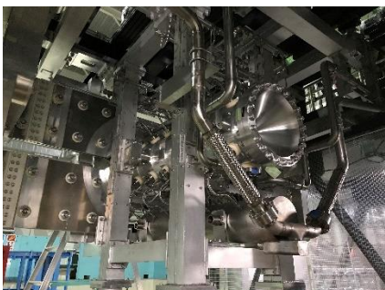
⑤ニュートリノビームライン電磁ホーン 所蔵: J-PARCセンター
