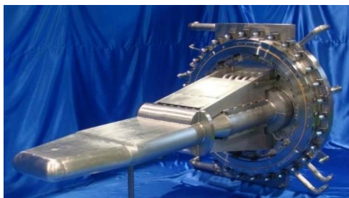
⑦中性子標的 (水銀ターゲット容器) 所蔵: J-PARCセンター
